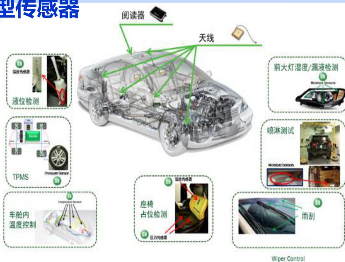
图1.23 汽车电喷系统、空调排污和自动驾驶系统的车载传感器
