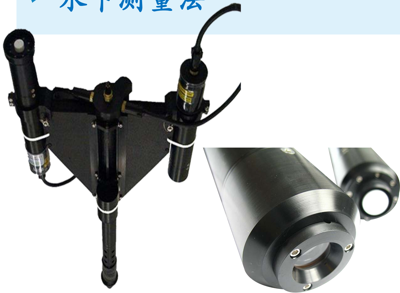
自由落体式的水色剖面测量
