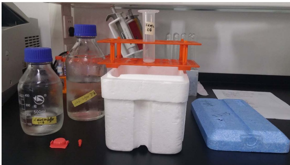
Picture 2 Ni-NTA柱置于冰上洗涤缓冲液、蛋白溶液、洗脱缓冲液依次过柱
