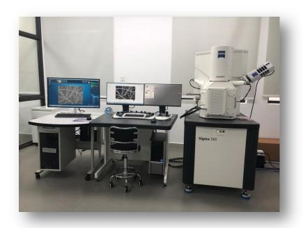
扫描电镜(SEM)是介于透射电镜和光学显微镜之间的一种微观形貌观察手段,可直接利用样品表面材料的物质性能进行微观成像。其优点是:放大倍数大,几十至几十万倍之间连续可调;景深大,视野大,成像富有立体感,可直接观察各种试样凹凸表面的细微结构。 Zeiss Sigma500 扫描电镜:放大倍率 10-100 万倍,加速电压 0.02-30kv,具有 SE 和 BSE 信号功能,配有牛津 80m2 能谱仪,分析元素范围: Be4-Cf98。
