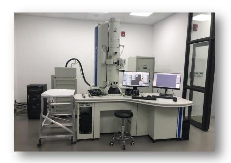
透射电镜(TEM)可对试样在纳米和埃的层级给出相应的物质结构信息,不仅能够直观地观测样品形貌,更能细致分析样品的精细结构,可与地质、化工、高分子科学、生命科学、医药学、材料、半导体等学科实现共享。JEOL Jem-2100plus:加速电压 200kv,点分辨率 0.194nm,线分辨率 0.14nm,可完成超高分辨成像、明暗场像、电子衍射、微结构分析、形貌分析、晶体结构确定等。
