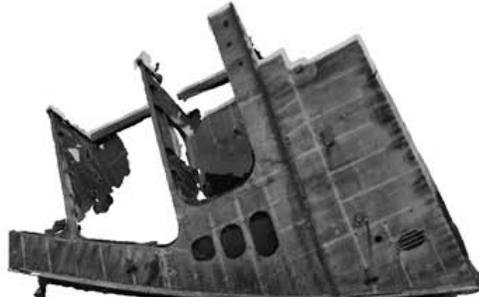
251 船 SL2 分段甲板的完整重建三维模型
